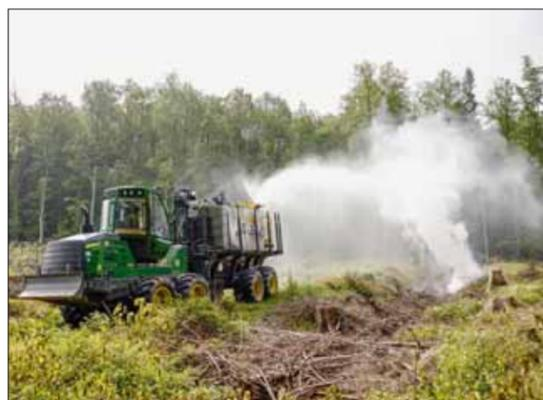
Der »Fire Fighter« kann bis zu 900 l Wasser pro Minute auf bis zu 50 m Entfernung ausbringen, die Betankung dauert sieben Minuten.
