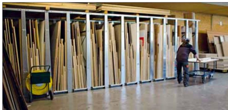
Die sich leicht nach oben hin verjüngenden Fachteiler im Vertikal-Plattenlagerregal (VLP) sorgen für ein gleichmäßiges Anlehnen der empfindlichen Holzwaren.
