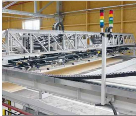
Das Lager für die Einschichtplatten wird vollautomatisch mit zwei Vakuumportalen betrieben.
