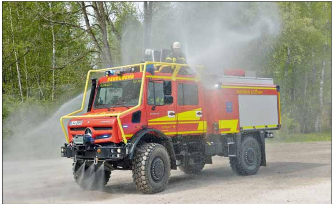
Das Fahrzeug verfügt über eine Reihe von Selbstschutzeinrichtungen.
