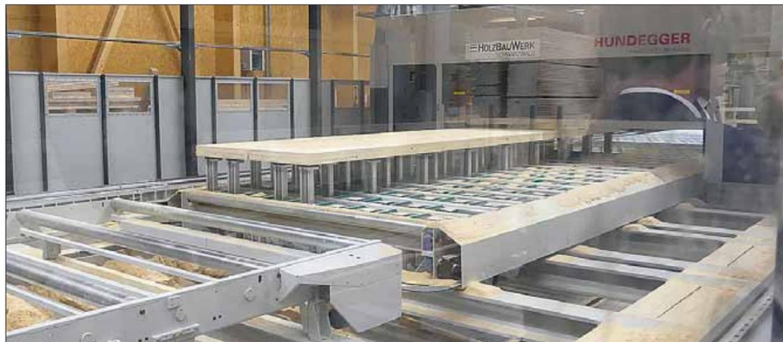
Der für HBW erstmals von Hundegger installierte Vakuumtisch mit 250 Vakuumstempeln ermöglicht die Bearbeitung eines Bauteils innerhalb des Plattennestings an den Plattenkanten und sogar im Randbereich auf der Plattenunterseite.
