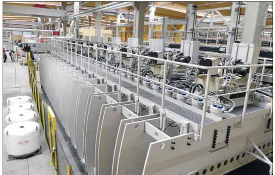
Die hydraulische Blockpresse für die Verleimung der Einschichtplatten ist ein Prototyp der Firma Weinig. Er besteht aus 16 einzelnen Pressrahmen, die sich auf jeweils unterschiedliche Plattenstärken einstellen können.
