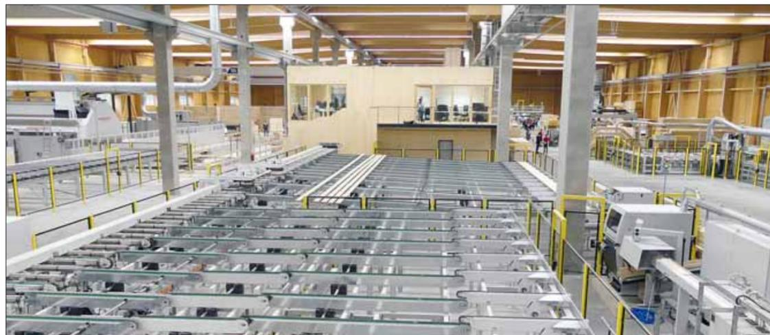
Blick in die Produktionshalle: Weing war als Gesamtlieferant für die Produktionsanlagen verantwortlich. Beginnend im Hintergrund rechts mit der Keilzinkung ist hier in der Bildmitte der Leitstand und die Kapung der Lamellen für die Längslage zu sehen, links die Abbundanlage – im Foto rechts Zuführung und Presse für die Querverleimung der Lamellen für die Mittellage.
